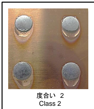
図6. ぬれ効力試験結果
