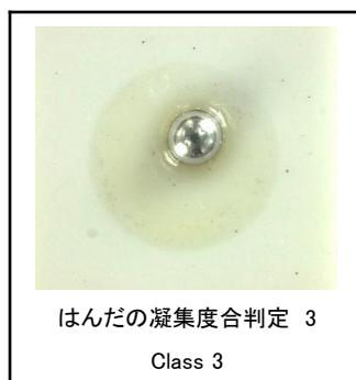
図7. ソルダーボール試験結果
